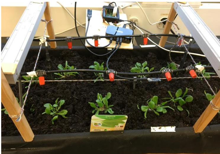
Figure 4 : Photo du bac de Cérès. On peut voir des plants d'épinard, un arrosage goutte-à-goutte avec des goutteurs en orange et des capteurs plantés dans la terre à gauche et à droite.
